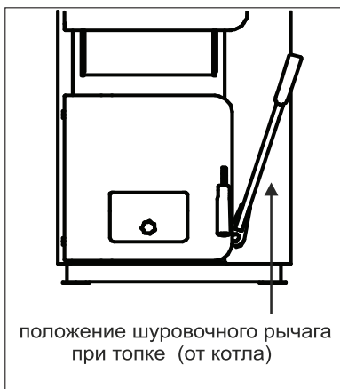
Рис.10 Установка рычага шуровочного механизма
